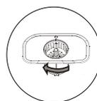
**A** 用流动水冲洗不锈钢渣篮，也可以用软毛刷清洗，但不可用铁刷或不锈钢丝球刷，这样会让不锈钢过滤器生锈。
